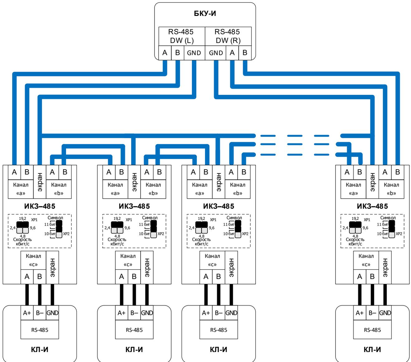
Рисунок 5 – подключение ИКЗ–485 в системе ПКТС «Олимп-И».
